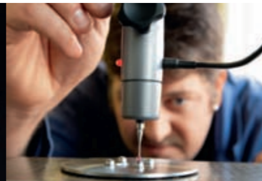
Die Alesa AG: Firmensitz in Seengen (ganz links), Ansicht einer HSS-DIN-Kreissäge (Mitte) und Kontrolle der Kreissägenaufnahme auf der 3-D-Messmaschine.
